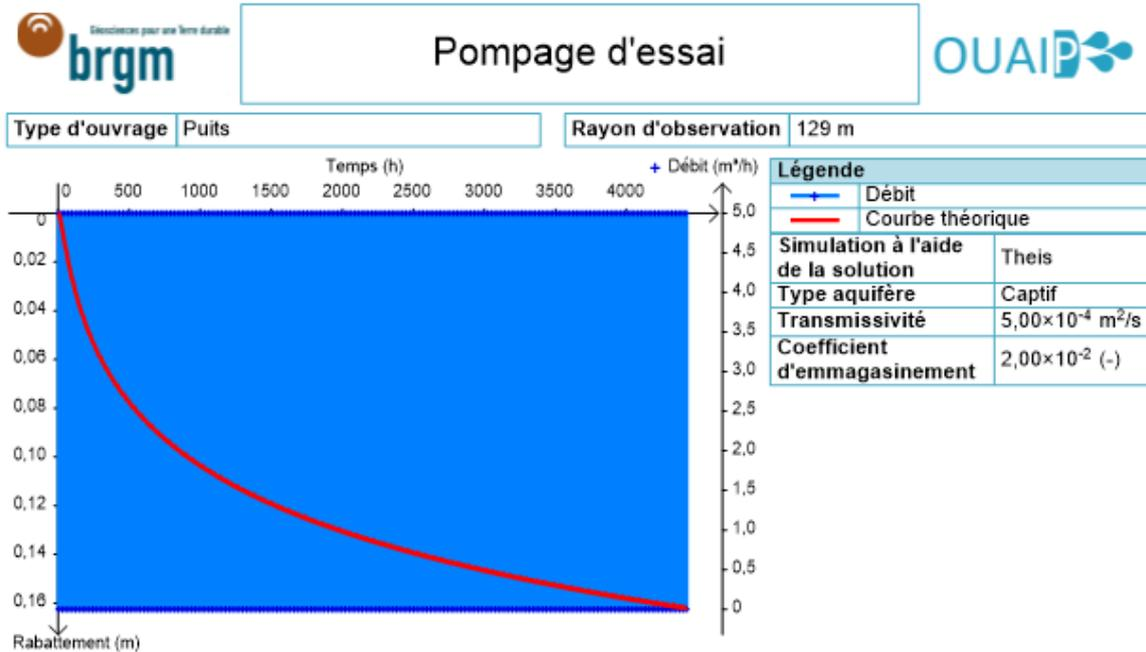
Les données de transmissivité et de coefficient d'emmagasinement sont issues de la banque de données du SIGES BRETAGNE (rayon < 4km autour du projet). La simulation a été réalisée à partir d'un prélèvement de 4h25 heures par jour à  $5 \text{ m}^3/\text{h}$  soit  $22 \text{ m}^3/\text{jour}$  pendant 180 jours sans prise en compte du phénomène de recharge de la nappe. L'effet du pompage sur la zone humide peut être considérée comme faible (inférieur à 0,16m).
